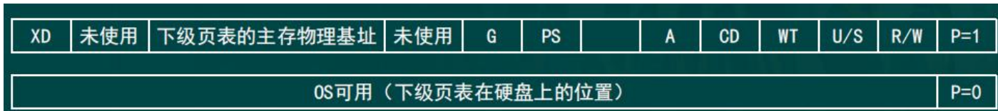
图5.35 Core i7中前三级页目录项（PDE）的结构
